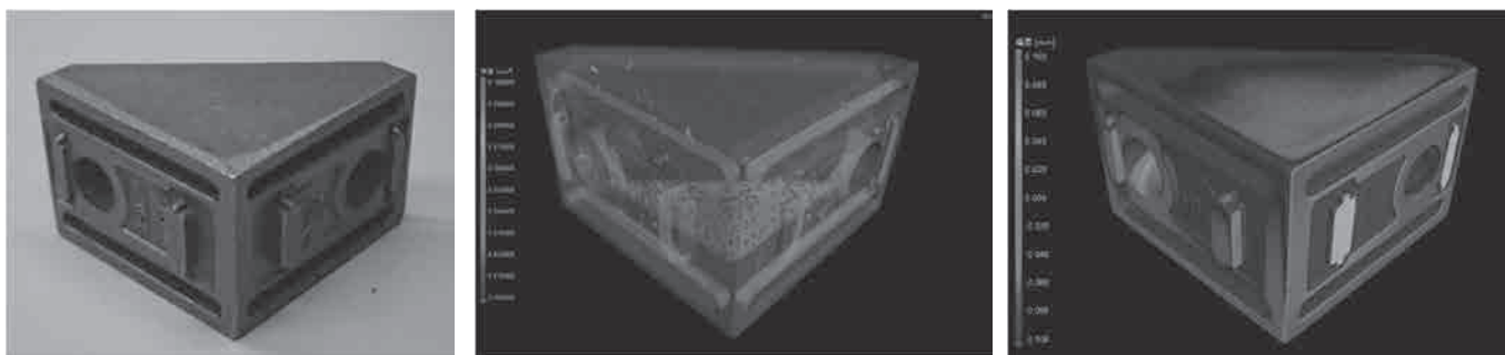
アルミフレーム直角接続ブラケット（中：欠陥解析結果、右：設計値／実測値比較）
